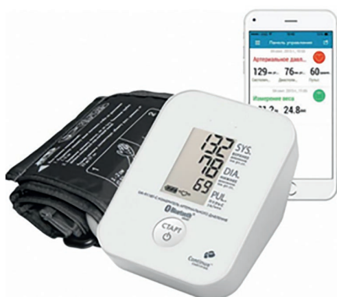
Рис. 1. Автоматический тонометр с функцией телеметрии. Из открытого доступа в сети Интернет Fig. 1. Automated pulsimeter with telemetering function. From open sources in the Internet
