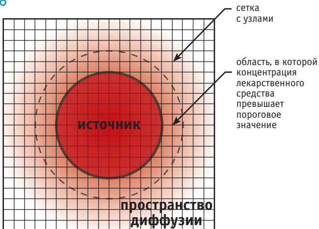
Рис. 1. Схематическое изображение универсального трехмерного виртуального фантома локальной области ткани. В качестве элементарного источника диффузии рассматривается сфера заданного радиуса — r_0 . Значения концентрации лекарственного средства оцениваются в узлах сетки из пространства диффузии. Сетка однородна и пересекает как пространство диффузии, так и область источника
